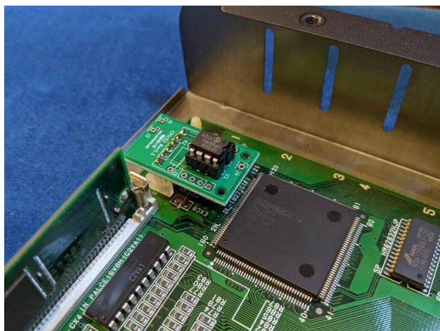
図 49 コネクタをはんだ面に取り付けた場合の一体型基板への装着
