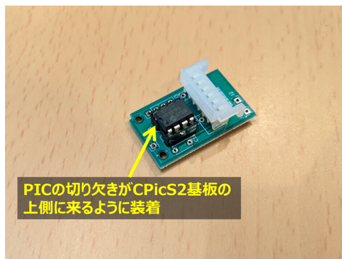
図 43 TYPE-B への PIC の装着
