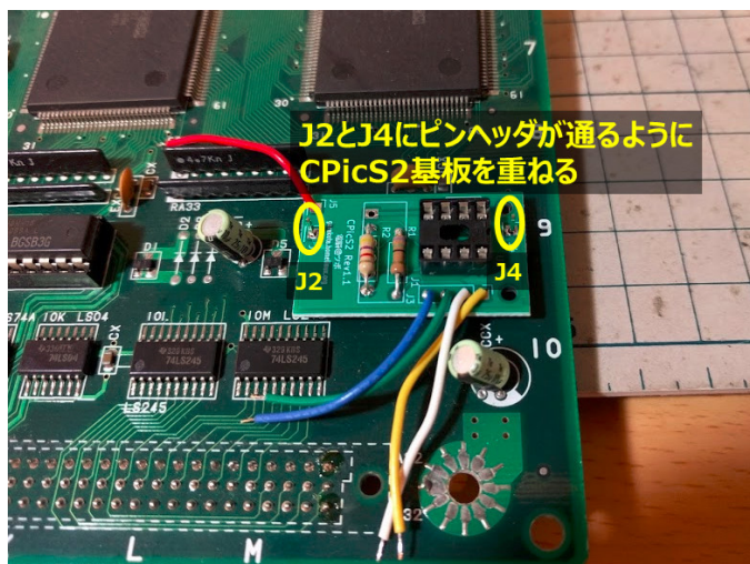
図 38 J2 と J4 にピンヘッダが通るように CPicS2 基板を重ねる
