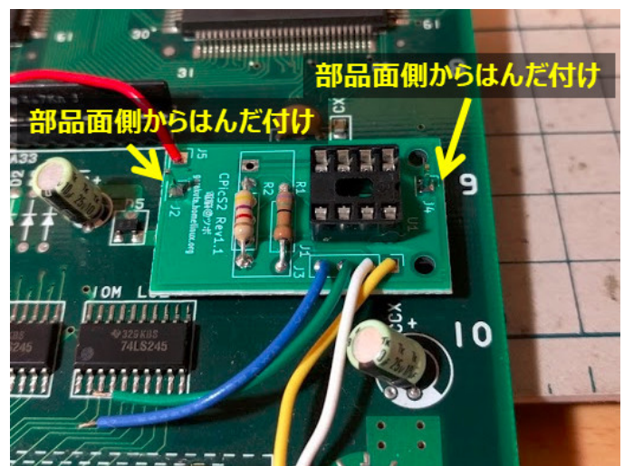
図 39 J2 と J4 をピンヘッダにはんだ付け
